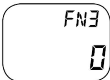
регулировка триммера канала 3 (LN режим только) более детально смотрите на стр. 34
