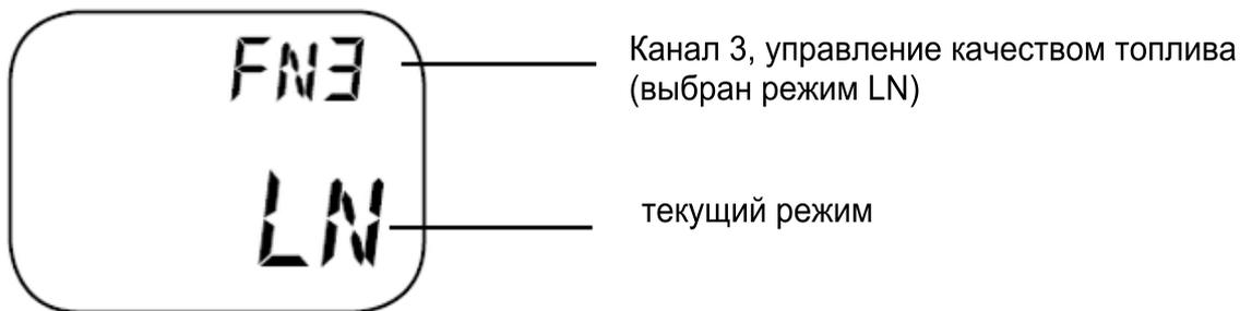
Когда выбран режим LN для канала 3 , рычаг А может быть использован для обогащения или обеднения топливной смеси двигателя. Как только достигнуто желаемое значение качества топливной смеси, значение регулировки рычагом А, высвечиваемое на дисплее, может быть вручную перенесено в функцию субтриммера (стр.26) а значение экрана FN3 возвращено в ноль. Пожалуйста, обратитесь к диаграмме А ниже для понимания процесса управления данной функцией.
